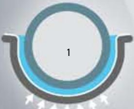
**Les cuvettes flottantes** Lapauw se positionnent automatiquement autour du rouleau et épousent parfaitement le contour du rouleau de la calandre tant du côté de l'entrée que de celui de la sortie.
